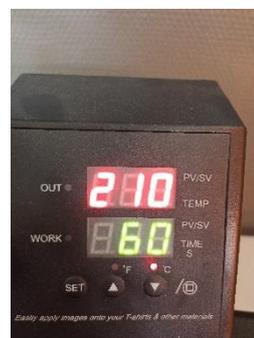
Des appuis successifs sur la touche **set** permettent de régler la température, le temps de sublimation et l'unité de température (°C ou Fahrenheit)
